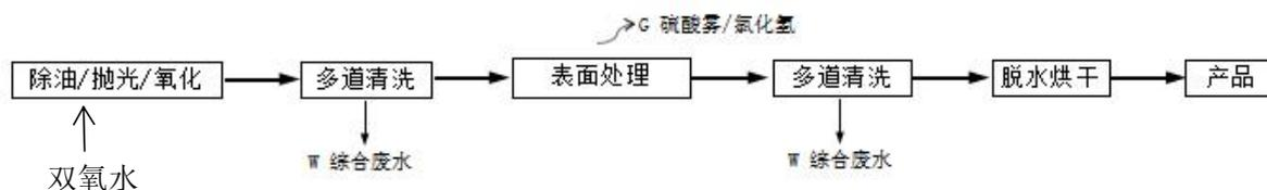
图 4-11 拉链化学镀生产工艺流程图
